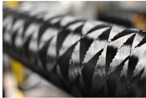
Enroulement matériaux thermodur. Et thermoplastique
